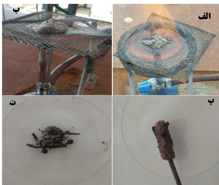
شکل ۳- تصویری از محصولات حاصل از آزمایش‌های مختلف بعد از فرایند سوختن: الف) روش ضایعات چوبی، ب) روش کربن، پ) روش کاغذ و ت) روش چوب کبریت.
