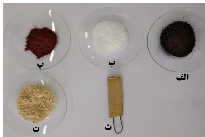
شکل ۱- مواد استفاده شده در این بررسی تحقیقاتی، الف) کربن، ب) سدیم کربنات، پ) آهن (III) اکسید، ت) پودر ضایعات چوبی و ث) تکه‌ای از ضایعات کاغذی.
