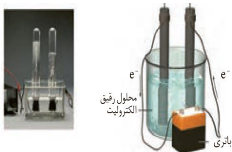
شکل ۲- برقکافت آب به کمک سلول الکترولیتی
